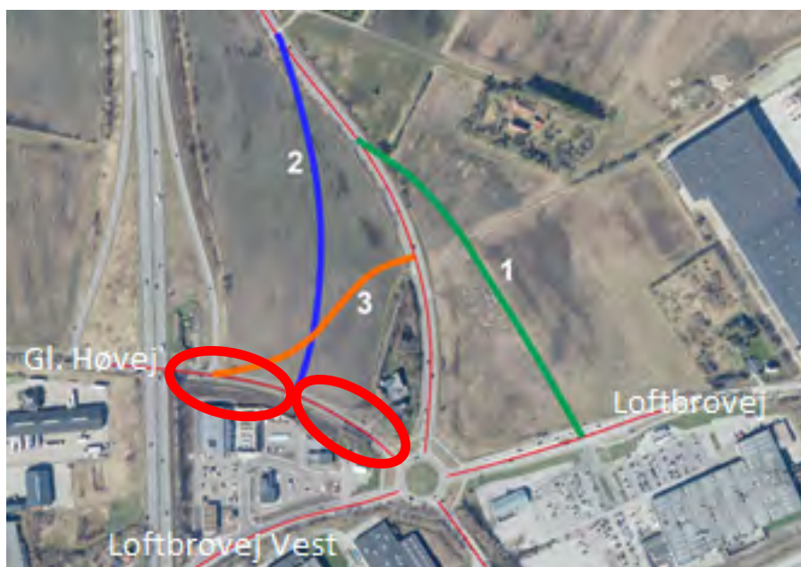
Figur 3. Forlægning af Hjørring Landevej til Gl. Høvej (blå – nr. 2) med rød markering af de problematiske afstande til E39 rampeanlæg og det fremtidige signalanlæg ved Loftbrovej.
