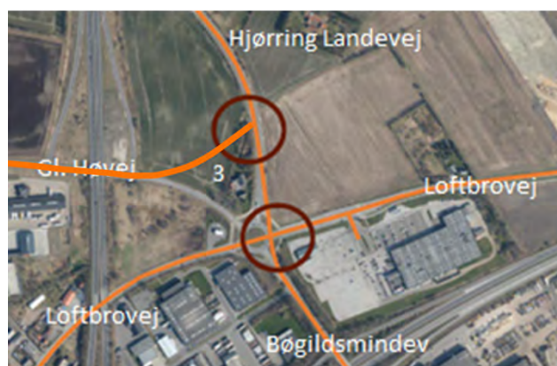
Figur 5 Forlægning af Gl. Høvej til Hjørring Landevej (orange – nr. 3)
